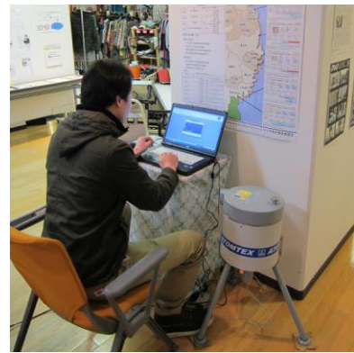
図9 シンチレーション型検出器による放射性物質濃度測定
