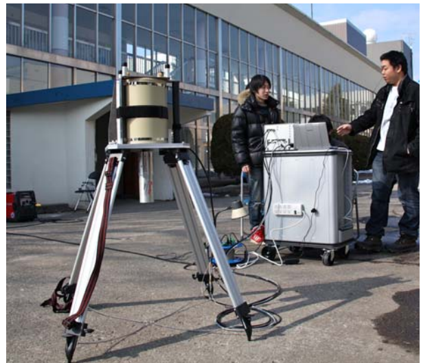
図6 放射線計測フィールドワーク ガソリンエンジン発電機からの電力供給によりゲルマニウム半導体検出器を屋外で使用し、地表等の放射性物質からの放射線を直接測定する。
