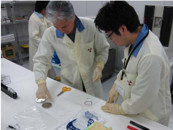
図4 放射線管理区域における放射線研修 ダストサンプラーにより捕集した空气中粉塵の放射性物質濃度を \alpha/\beta ガスフローカウンタで計測するための作業をしている
