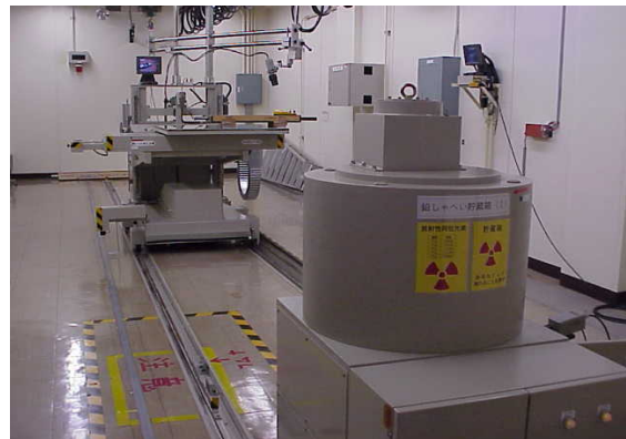
照射装置(Co-60線源)の外観 サーベイメータ等の校正及び特性試験の実習に 使用する照射装置(線源貯蔵)の外観を示す。
