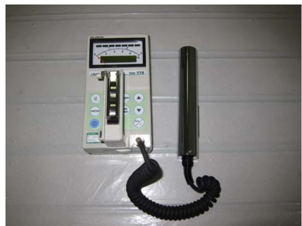
④シンチレーションサーベイメータ 装置の外観を示す。
