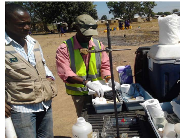
ガーナ北部で化学・同位体分析のために井戸から地下水のサンプリングを行っている様子(写真:IAEA)
